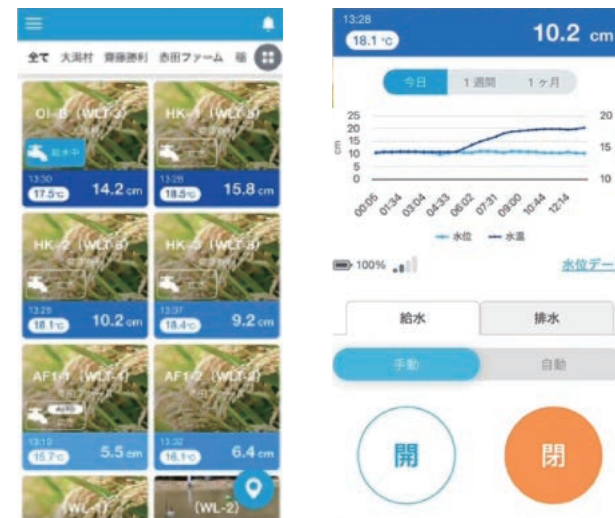
自分のスマホで水位の確認、給水ゲートの開閉操作が可能
