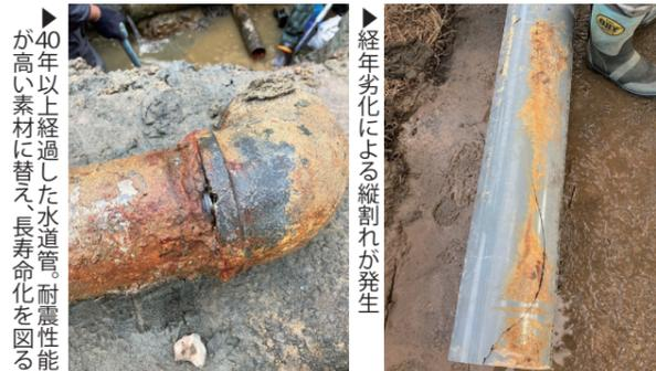
▶40年以上経過した水道管、耐震性能が高い素材に替え、長寿命化を図る
