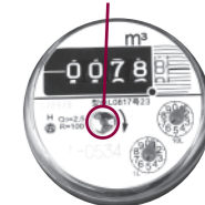
メーターパイロット
