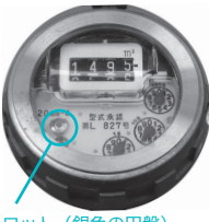
パイロット（銀色の円盤） 回っていないか確認しましょう
